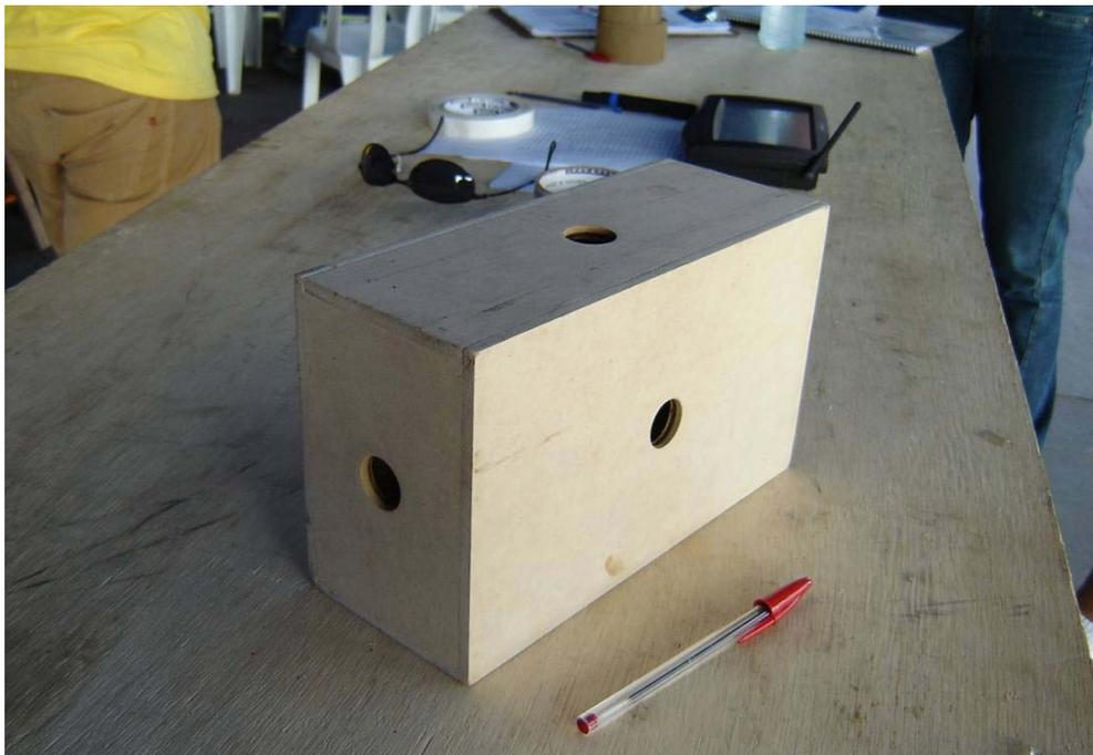
**Não poderá haver interferências de nenhum elemento da aeronave com o volume delimitado pelo bloco de madeira e, para a inserção deste bloco no espaço interno delimitado pelo compartimento não deverá ser necessária a mínima aplicação de força (o ajuste deve ser deslizante).**
