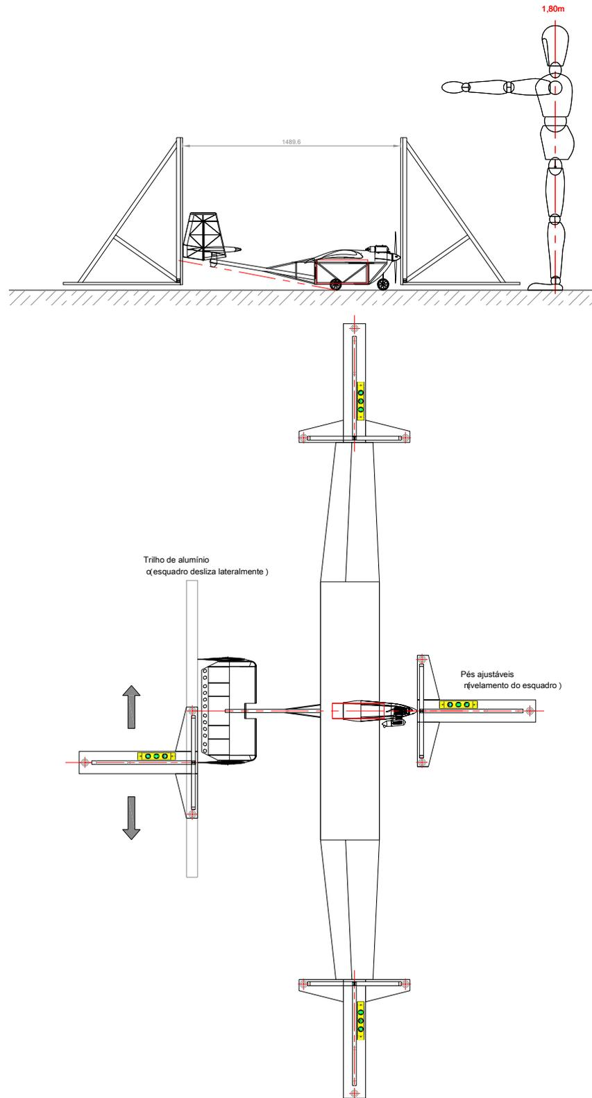
Todas as medidas deverão ser tomadas com as faces verticais dos esquadros perpendiculares ao plano de referência (ou piso da tenda). Cada esquadro é composto por três pontos de apoio reguláveis e nível de bolha em dois eixos.
